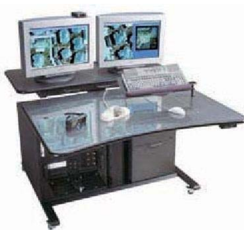
Figura III.2 – Estação fotogramétrica Image Station 2001 (fonte: ImageStation factsheet )
