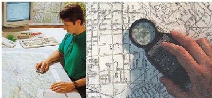
Figura II.11 – Extração através da utilização de mesa digitalizadora
