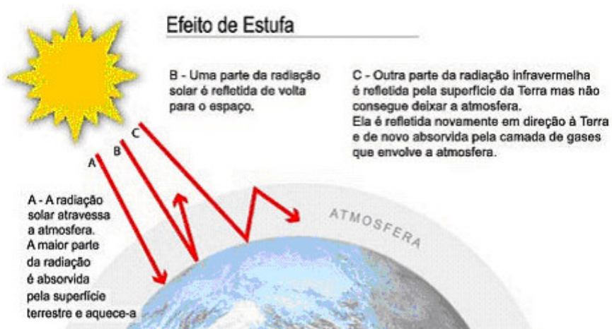
Figura 2: Esquema do fluxo de radiação infravermelha entre a Terra e o espaço [3].
