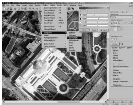
Figura 2.31 - Ferramenta de software de uma estação fotogramétrica. Fonte: Vinnitsa (2004).
