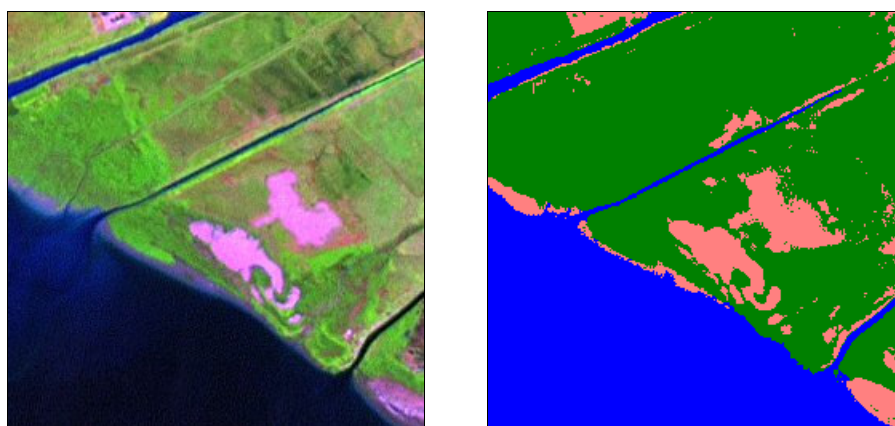
Figura 2.9 Imagem da superfície terrestre (à esquerda) e o resultado de um processo de classificação (à direita). Os dados originais são transformados em informação pelo processo classificatório, gerando-se como resultado um mapa temático de uso e cobertura do solo. Neste caso, áreas em azul correspondem a água, verde a áreas cobertas por vegetação, e rosa/alaranjado a áreas de solo exposto.
